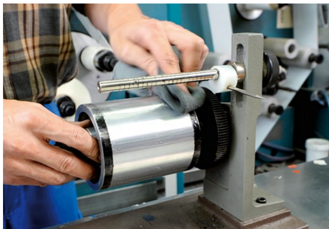
Entfernen des Schleifstaubs nach der Reinigung mit einem Schleifmittel.
